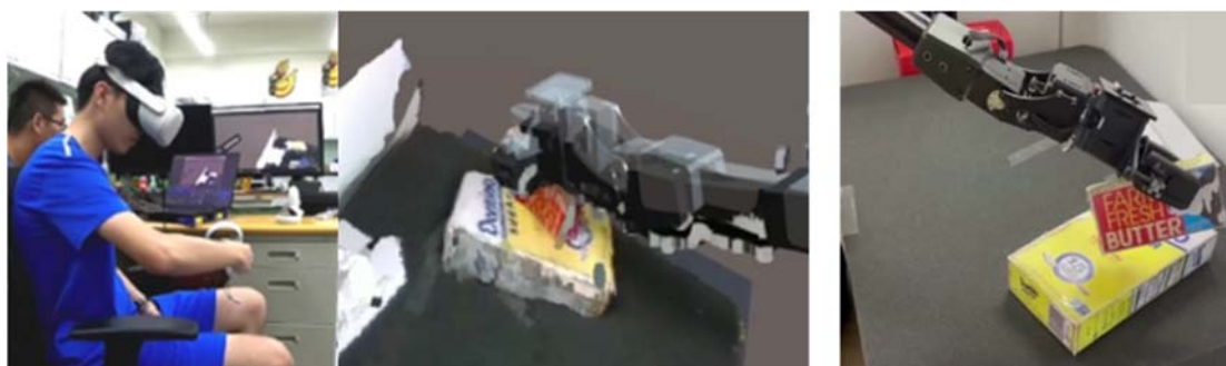
圖一、本研究之虛擬實境遠端操作機器人系統。左圖顯示使用者操作本研究設計的虛擬實境介面，該介包含三維工作環境的重建、命令預覽功能以及當前機器手臂的位置與狀態呈現；右圖則展示機器手臂在遠端執行操作時的實際情況。
