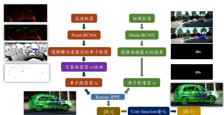
圖 4、自駕車多感測器線上校正演算法
